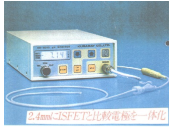
② Catheter pH, PCO 2 monitor (Kurare, Nihon Kohden)
